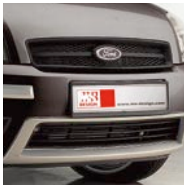
Obramowanie wlotu chłodnicy pianka poliuretanowa (niegruntowana), srebrna lub do lakierowania w kolorze nadwozia MSD.FO50.02.01KG
